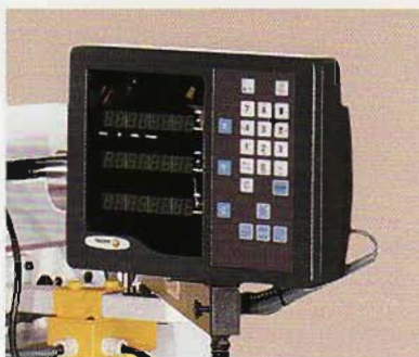
Visualizador. Digital readout. Digitale Positionsanzeige. Visualisateur des Cotes.
